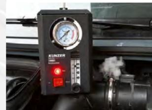
Professioneller Nebel- bzw. Raucherzeuger für die Lecksuche oder zur Dichtheitsprüfung an Kühlsystemen, Ansaug- und Abgasanlagen, Turboleitungen und generell zum Auffinden von Undichtigkeiten in Leitungssystemen.
